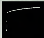
Bild 96. Darstellung der Kollektorstrom-Kennlinie eines Transistors
