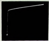
Bild 96. Darstellung der Kollektorstrom-Kennlinie eines Transistors
